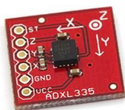
Fig.4.8. Acelerómetro de tres ejes
