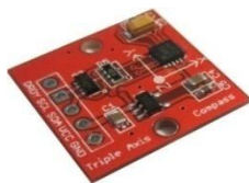
Fig.4.9. Magnetómetro de tres ejes
