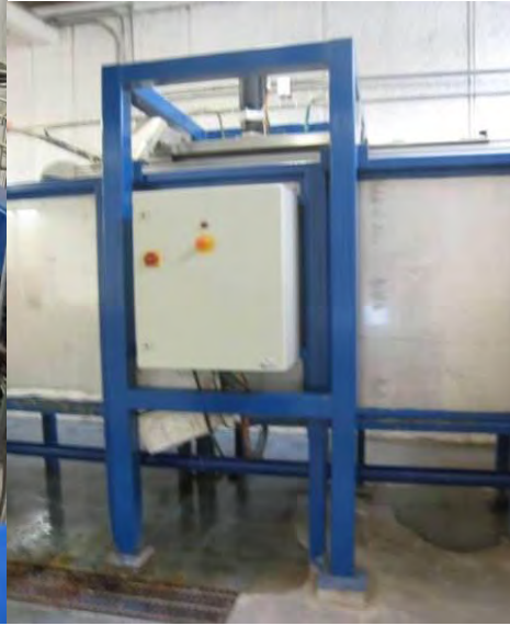
Figura A2. Soporte del sistema de generación de oleaje (1) y motor eléctrico (2).
