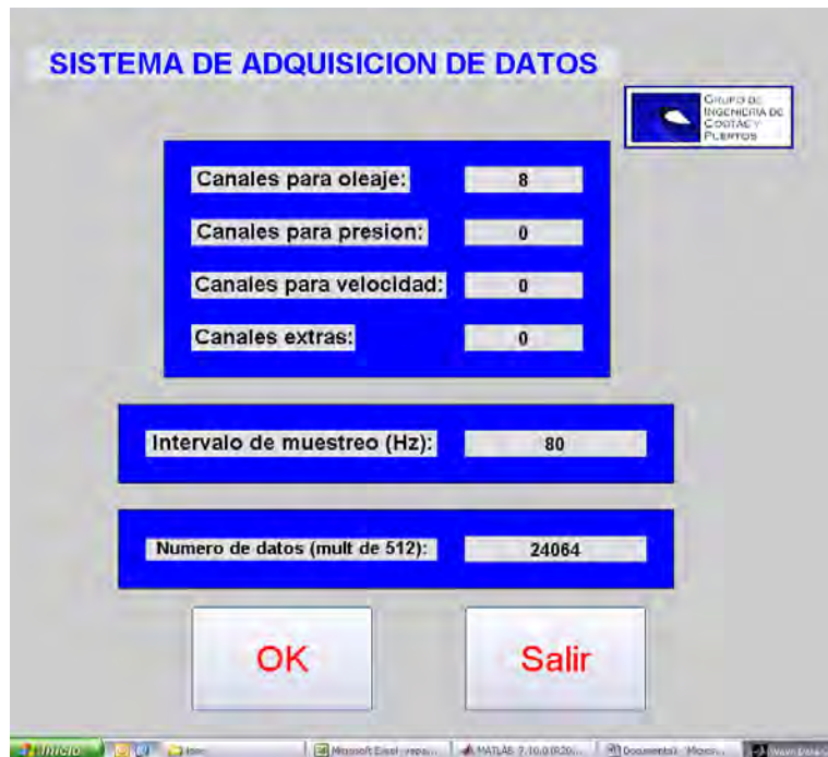
Figura A12. Ventana del programa WDC, donde de ingresarán el número de datos obtenidos por cada segundo de tiempo y el tiempo de duración del ensayo.
