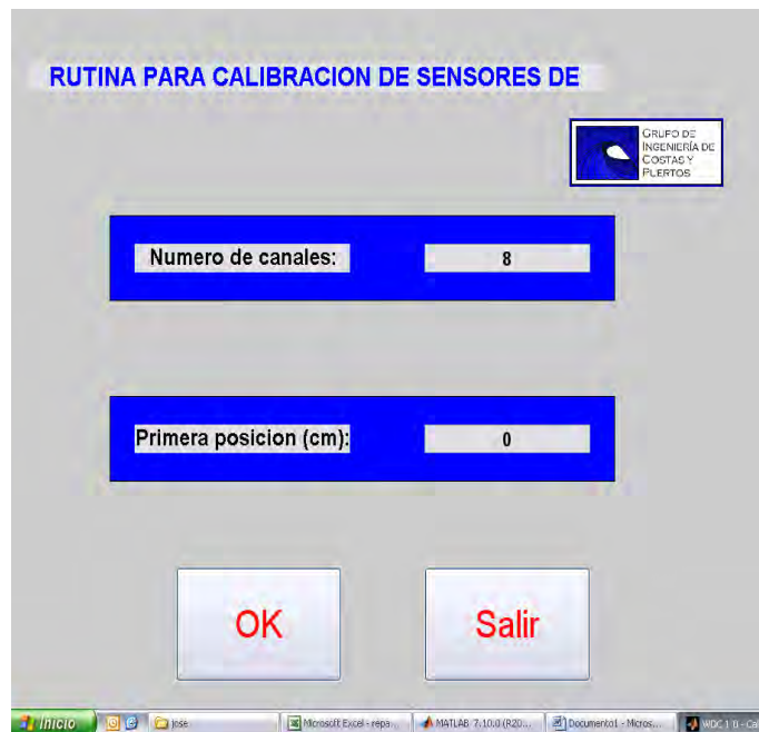
Figura A9. Ventana del programa WDC, donde se ingresarán el número de sensores o canales que se utilizarán y la primera posición (0) de calibración.
