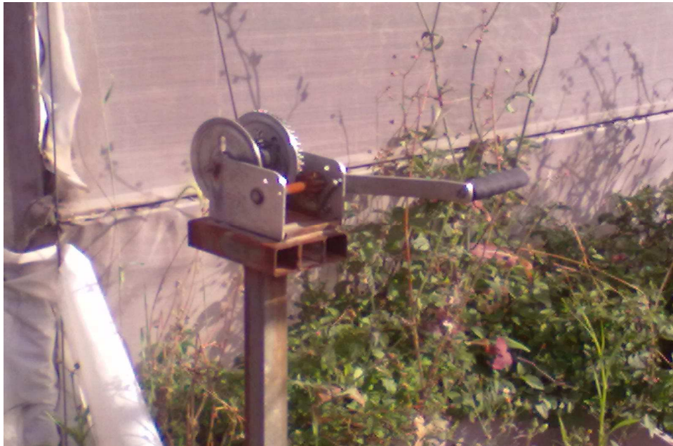
Imagen 4.12 Mecanismo de apertura y cierre de la cortina lateral de un invernadero.
