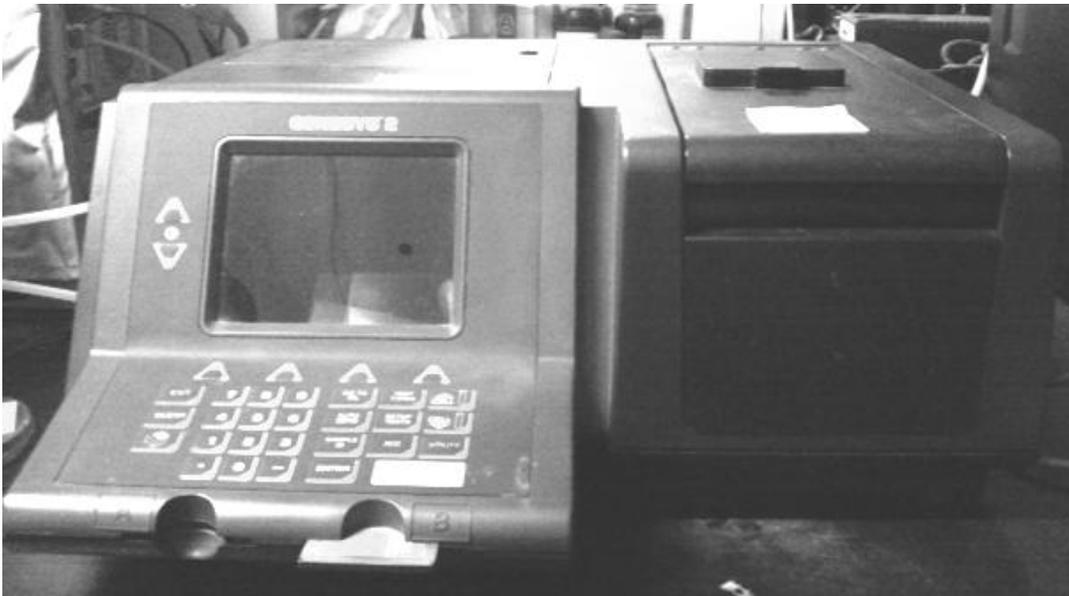
**Figura 2.5.1. Espectrofotómetro Genesis 2.**
