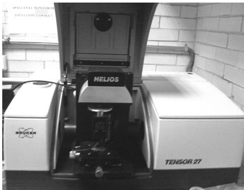
Fig. 2.4.1. Espectrofotómetro Infrarrojo Bruker Tensor 27 FT-IR.
