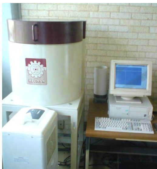
Figura 18. Detector de centelleo sólido de NaI activado con Tl. Modelo Bicon LS6500 de 3x3 pulgadas conectado a una PC cargada con el programa Maestro para detección radiactiva.
