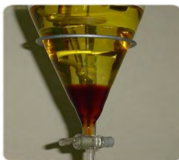
Figura 1.2 Fases de la reacción de transesterificación.
