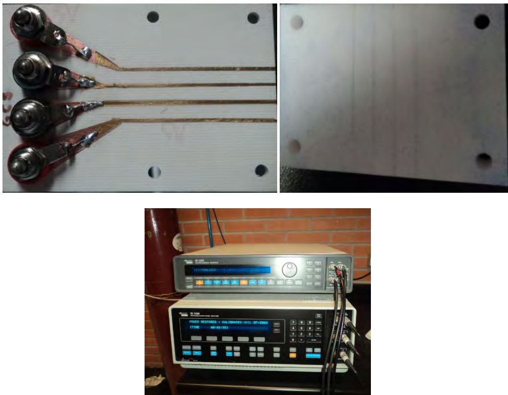
Fig. 18. Dispositivo de 4 electrodos y potenciostato empleado para la medición de la impedancia.
