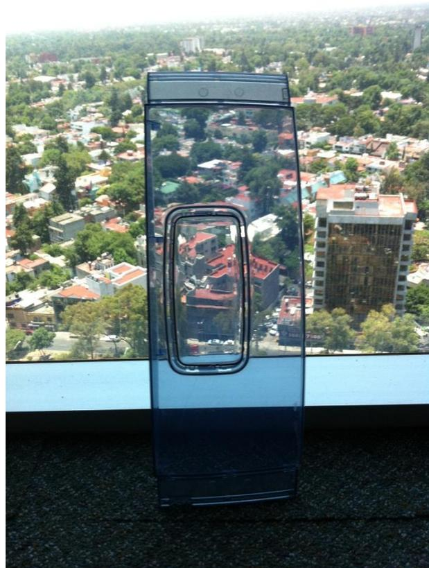
En este proyecto el producto con el que se fabricaba con anterioridad la tapa (ABS Transparente) tenía algunos problemas de quiebre al momento del transporte y también al momento de que se llevaba a cabo el ensamble. Durante el ensamble, la pieza moldeada en color azul es ensamblada con un marco en color blanco. En algunas ocasiones la pieza cedía y había quiebres. Lo anterior representa una pérdida para la empresa ya que todas las piezas rotas en ensamble
