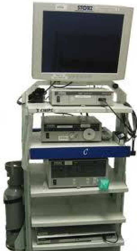
Puerto rígido, endoscopio flexible y torre con pantalla, fuente de luz y grabadora de video
