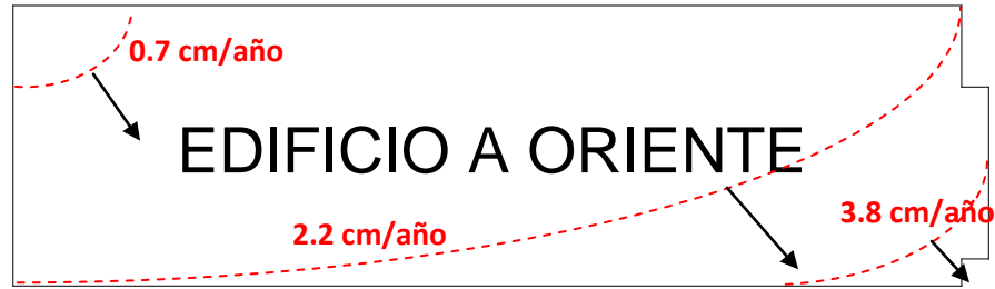
Figura 3.83 Vectores de inclinación cualitativos, edificio A Oriente
