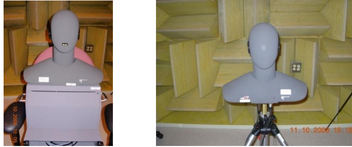
Figura 4-1: Maniqués con los que se realizó la grabación binaural. El maniqué HSM II.3 (izquierda) reprodujo la señal de voz, mientras que el maniqué HSM III (derecha) grabó la señal.
