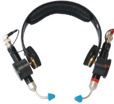
Figura 4-16: Micrófono binaural BHM III.2 empleado para las mediciones de las HRTF.
