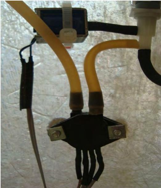
Figura 4.4. Sensor de presión MPX10DP montado en el modelo de fibra de vidrio
