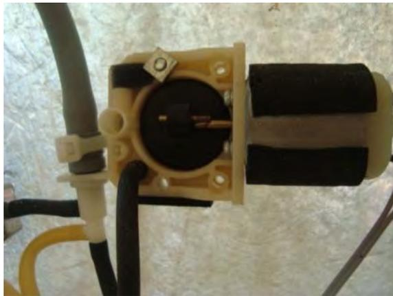
*Figura 4.2.* Bomba para inflado de la bolsa que simula la presión anal
