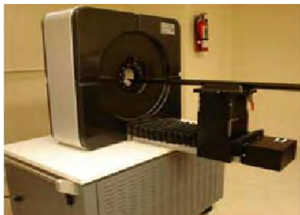
Figura 3.8 Equipo microPET Focus 120 (Concorde, Siemens Inc, Knoxville, TN) de la Unidad PET/CT-Ciclotrón, UNAM.
