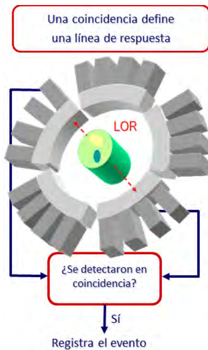
Figura 3.5 Línea de respuesta (LOR) o detección en coincidencia que determina si el evento es registrado. Imagen cortesía del Dr. Héctor Alva Sánchez.
