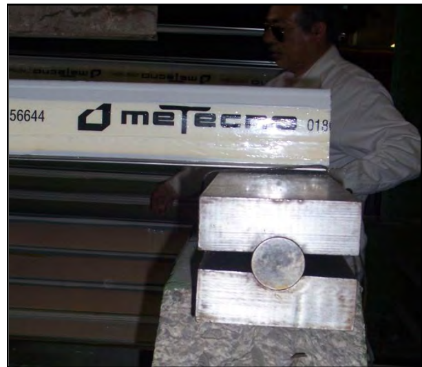
Figura 2-3. Apoyo articulado fijo
