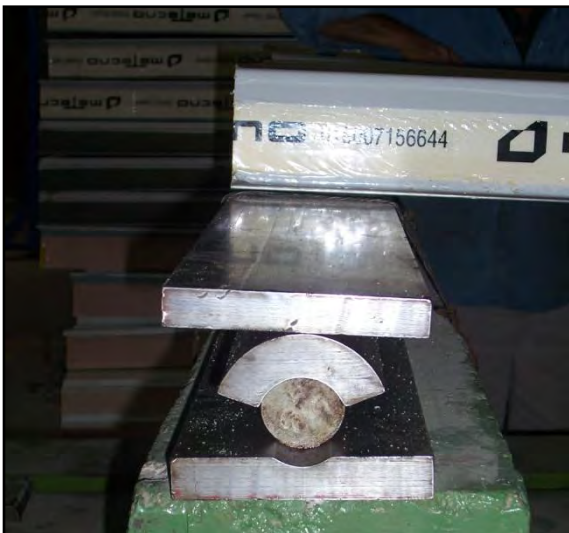
Figura 2-2. Apoyo articulado móvil
