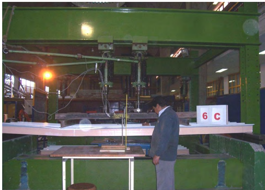
Figura 3-3. Inspección de la placa y retiro de instrumentos
