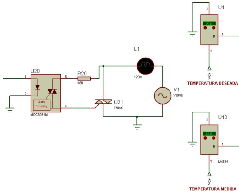
Si la temperatura deseada es mayor que la temperatura medida significa que las resistencias deben estar encendidas por lo que en la simulación la lámpara se enciende.
