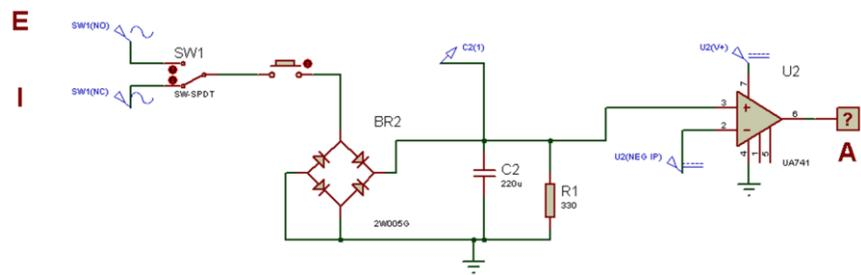
Este circuito solo sirve para determinar si se ha hablado. La salida B tendrá 5V cuando se esté hablando y 0V cuando no se hable. Nótese que la señal que entra al circuito no necesita estar filtrada para obtener un valor constante.
