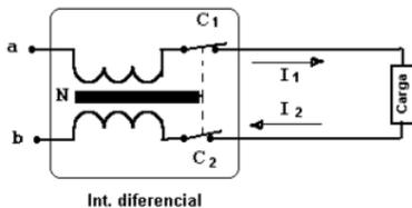
La corriente  $I_1$  que circula entre el punto a y la carga debe ser igual a la corriente  $I_2$  que circula entre la carga y el punto b. Por lo tanto los campos magnéticos creados por ambas bobinas son iguales y opuestos, por lo que la resultante de ambos es nula. Éste es el estado normal del circuito.
