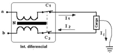
Si la carga presenta una derivación a tierra por la que circula una corriente de fuga  $I_f$ , se tiene que la corriente  $I_2$  es menor que la corriente  $I_1$ . La diferencia entre  $I_1$  e  $I_2$  produce un campo magnético resultante no nulo que genera una atracción sobre el núcleo N, provocando la apertura de los contactos  $C_1$  y  $C_2$  e interrumpiendo el paso de corriente hacia la carga.
