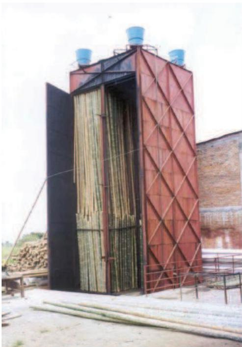
Ilustración 33: Horno vertical para ahumado de guadua. Fuente: Montoya Arango, Jorge A., Preservación y secado.
