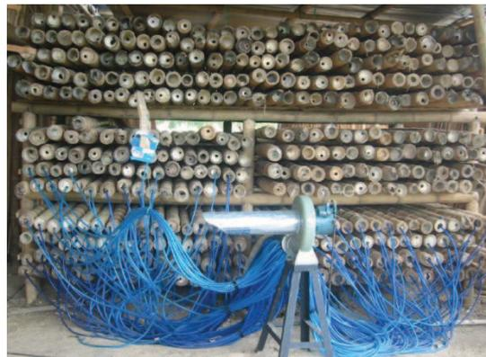
Ilustración 32: A la izquierda método de secado al aire libre, a la derecha método de secado por inyección de aire.
