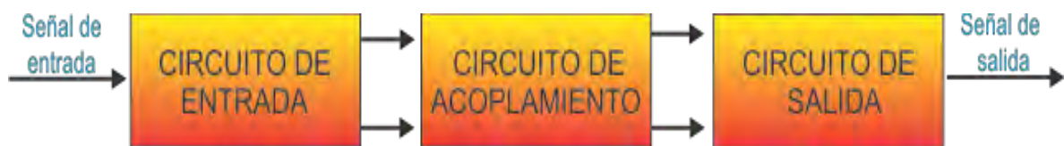
Figura 3-8. Diagrama de bloques que conforman a un relevador.
