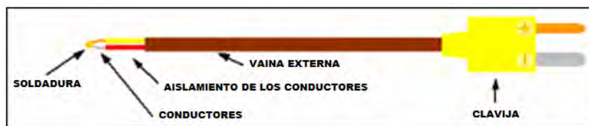
Figura 2-3. Partes que conforman a un termopar.
