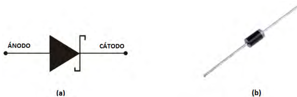
Figura 3-29. Símbolo del diodo Schottky (a) y su imagen real (b).
