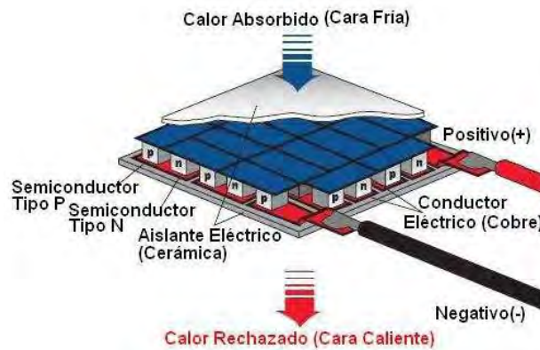
Figura 3-43. Diagrama en donde se muestra la estructura interna de una Celda Peltier.
