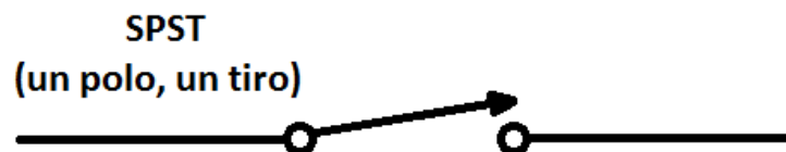
Figura 3-9. Símbolo común para representar a un interruptor de polo sencillo, interruptor sencillo.
