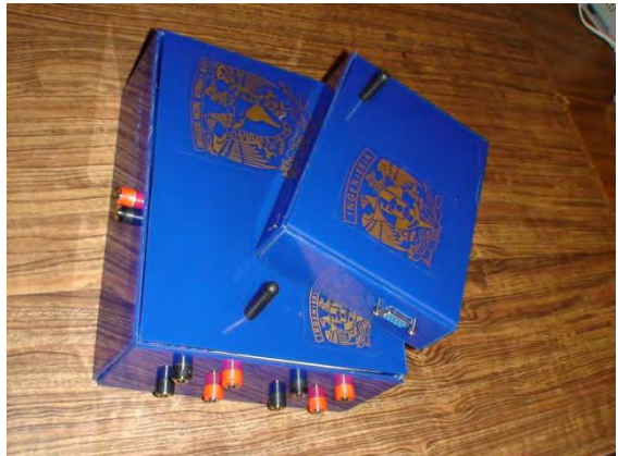
Figura 32. El circuito emisor y receptor dentro de sus gabinetes.
