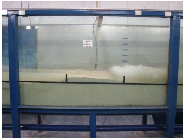
Figura A.8 Evolución del perfil de playa en la zona de rompientes para T=3s , H=12cm , \phi=1in y t=060min .
