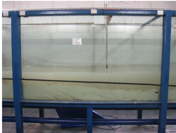
Figura A.5 Evolución del perfil de playa en la zona de someramiento para T=3s , H=12cm , \phi=1in y t=240 min .
