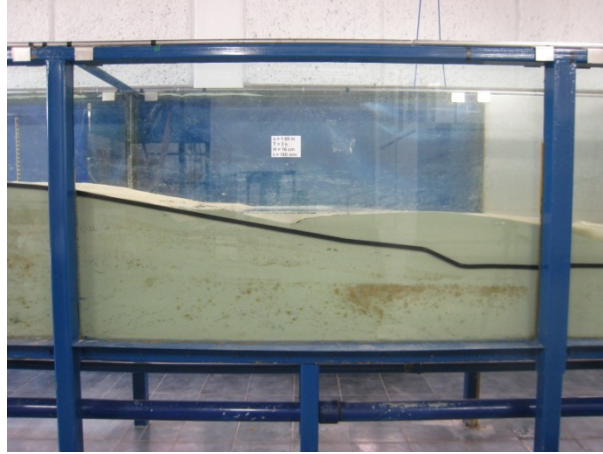
Figura A.16 Evolución del perfil de playa en la zona de lavado para T = 3s , H = 12cm , \phi = 1in y t = 120min .
