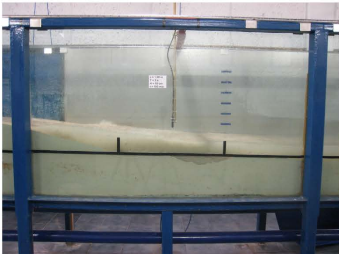
Figura 5.7 Forzamiento de la rotura sobre el tapete.
