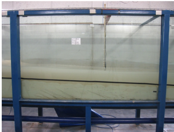
Figura A.3 Evolución del perfil de playa en la zona de someramiento para T=3s , H=12cm , \phi=1in y t=120min .
