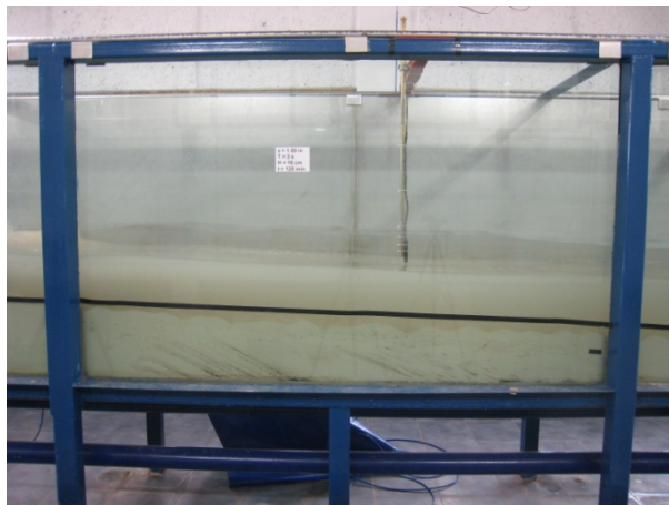
Figura B.3 Propagación del oleaje sobre el perfil de playa. Zona de someramiento.
