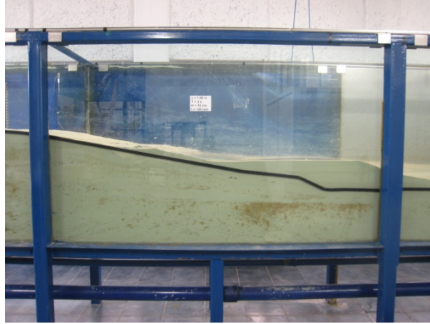
Figura B.7 Propagación del oleaje sobre el perfil de playa. Zona de lavado.
