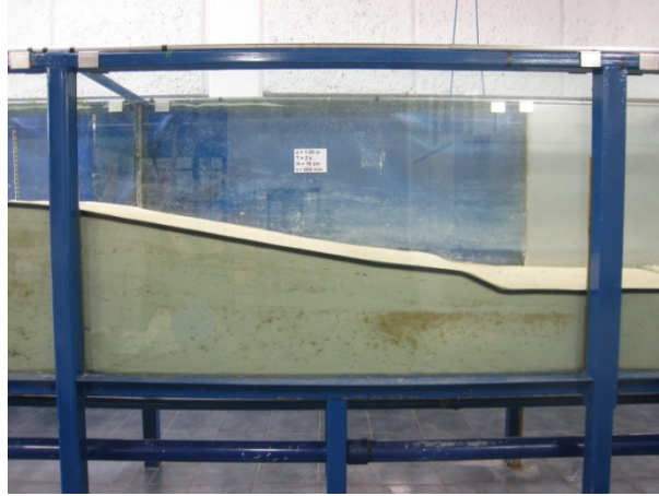
Figura A.13 Evolución del perfil de playa en la zona de lavado para T=3s , H=12cm , \phi=1in y t=000min .
