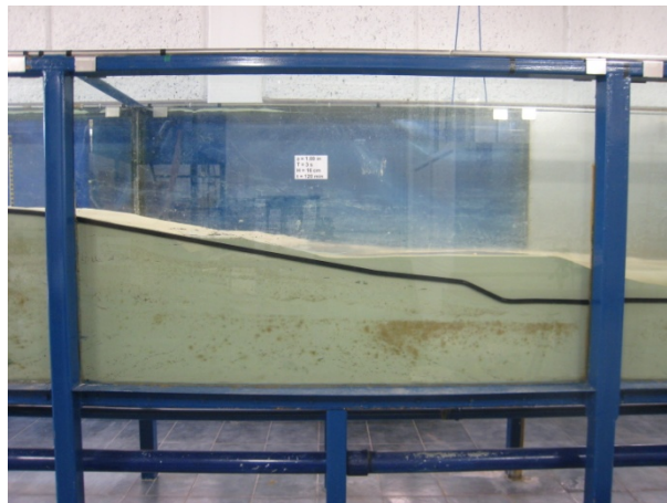
Figura B.9 Propagación del oleaje sobre el perfil de playa. Zona de lavado.
