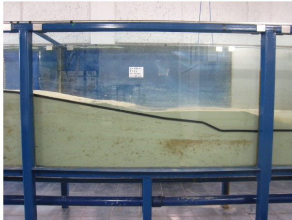
Figura B.8 Propagación del oleaje sobre el perfil de playa. Zona de lavado.
