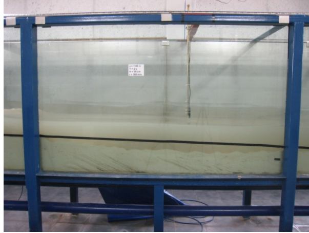
Figura A.4 Evolución del perfil de playa en la zona de someramiento para T=3s , H=12cm , \phi=1in y t=180 min .
