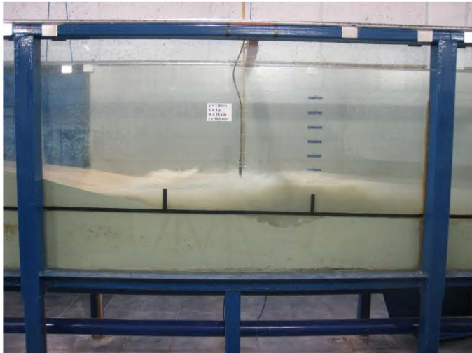
Figura 5.6 Forzamiento de la rotura sobre el tapete.
