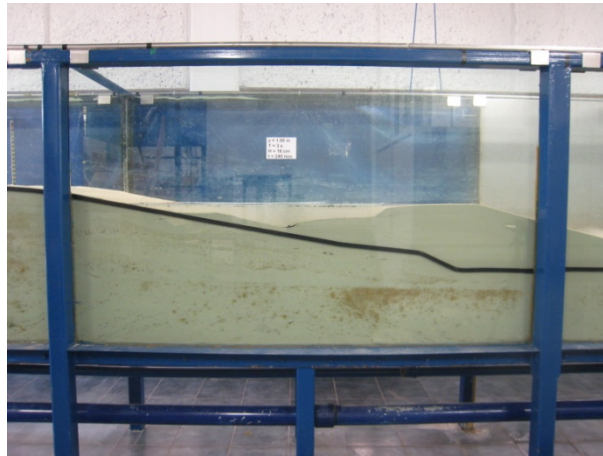
Figura A.17 Evolución del perfil de playa en la zona de lavado para T = 3s , H = 12cm , \phi = 1in y t = 240min .
