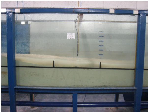
Figura B.6 Propagación del oleaje sobre el perfil de playa. Zona de rompientes.
