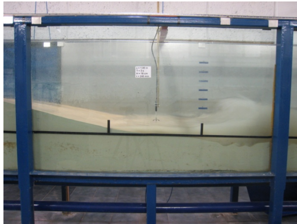
Figura A.11 Evolución del perfil de playa en la zona de rompientes para T=3s , H=12cm , \phi=1in y t=240min .
