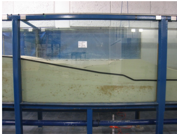
Figura A.18 Evolución del perfil de playa en la zona de lavado para T = 3s , H = 12cm , \phi = 1in y t = 293min .
