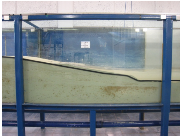
Figura A.14 Evolución del perfil de playa en la zona de lavado para T=3s , H=12cm , \phi=1in y t=060min .
