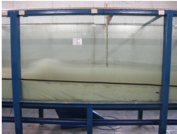
Figura B.2 Propagación del oleaje sobre el perfil de playa. Zona de someramiento.
