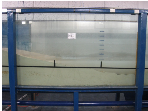
Figura A.12 Evolución del perfil de playa en la zona de rompientes para T=3s , H=12cm , \phi=1in y t=293min .
