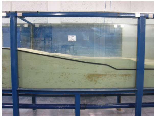
Figura A.15 Evolución del perfil de playa en la zona de lavado para T=3s , H=12cm , \phi=1in y t=120min .
