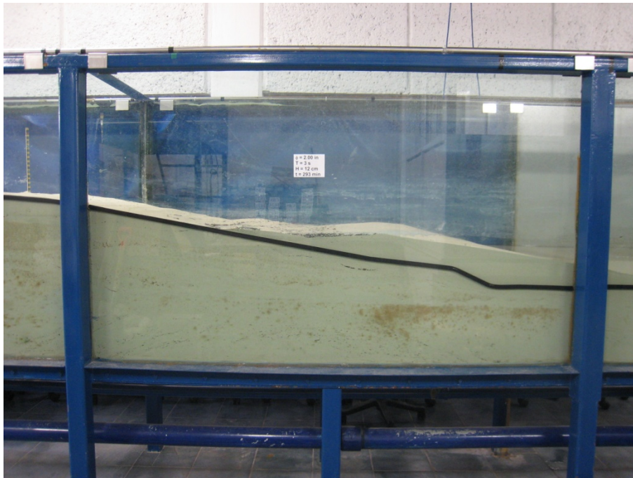
Figura 4.11 Configuración deformada del perfil de playa para periodo T=3s , altura de ola H=12cm , tiempo t=293min y tapete con grava de diámetro \phi=2in .
