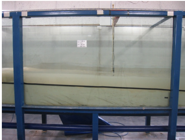
Figura A.2 Evolución del perfil de playa en la zona de someramiento para T=3s , H=12cm , \phi=1in y t=060min .
