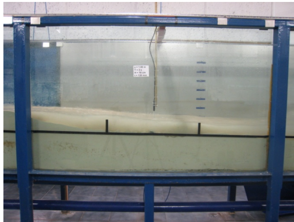
Figura A.9 Evolución del perfil de playa en la zona de rompientes para T=3s , H=12cm , \phi=1in y t=120min .
