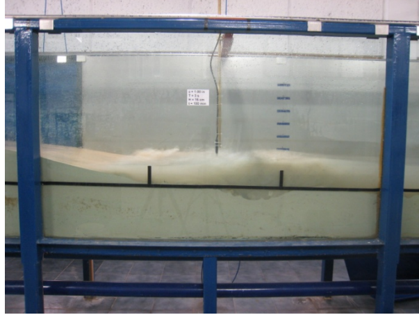
Figura A.10 Evolución del perfil de playa en la zona de rompientes para T=3s , H=12cm , \phi=1in y t=180min .
