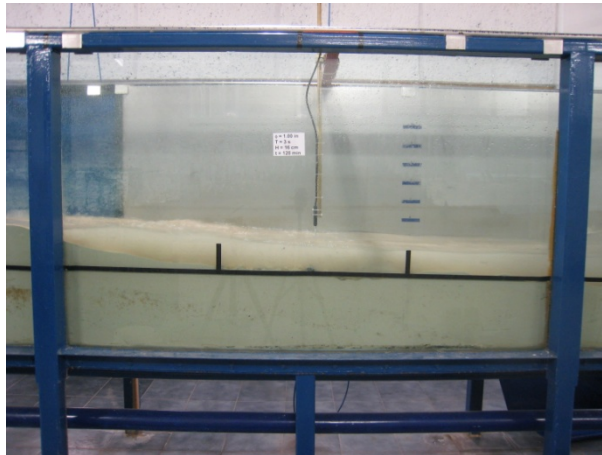
Figura B.5 Propagación del oleaje sobre el perfil de playa. Zona de rompientes.
