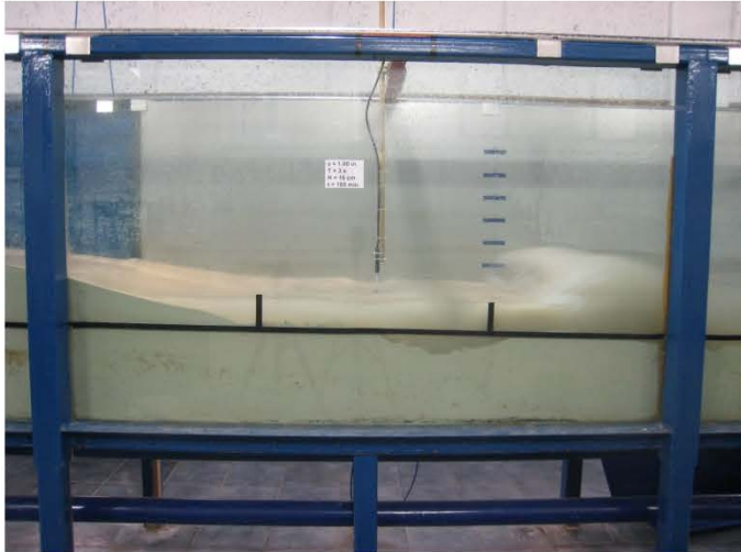
Figura 5.5 Forzamiento de la rotura sobre el tapete.
