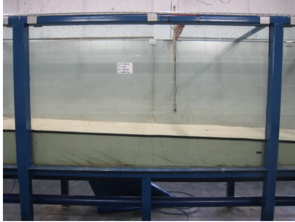
Figura A.1 Evolución del perfil de playa en la zona de someramiento para T=3s , H=12cm , \phi=1in y t=000min .
