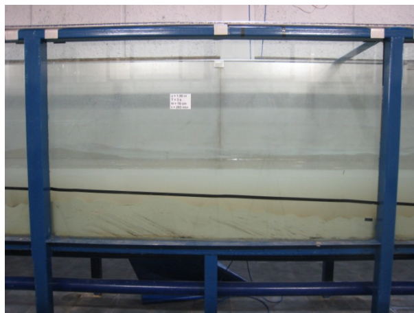
Figura A.6 Evolución del perfil de playa en la zona de someramiento para T=3s , H=12cm , \phi=1in y t=293 min .
