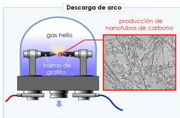
Figura 1.15. Esquema del método de síntesis por descarga de arco. Modificado de Kageyama, 2007 [40].
