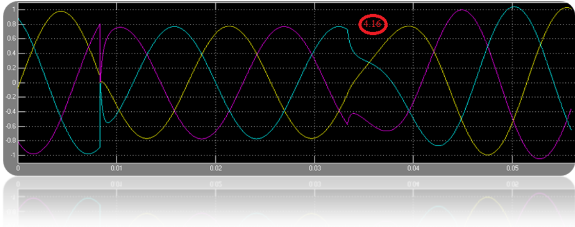
Figura 4.16. Re-cierres de los interruptores 1 y 2
