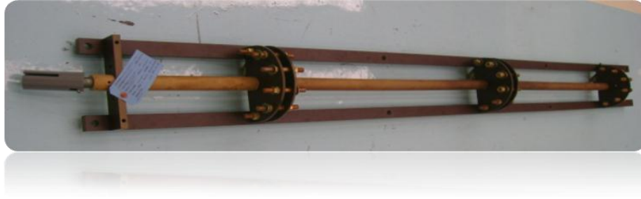
Figura 3.1. Cambiador de derivaciones de operación sin carga
