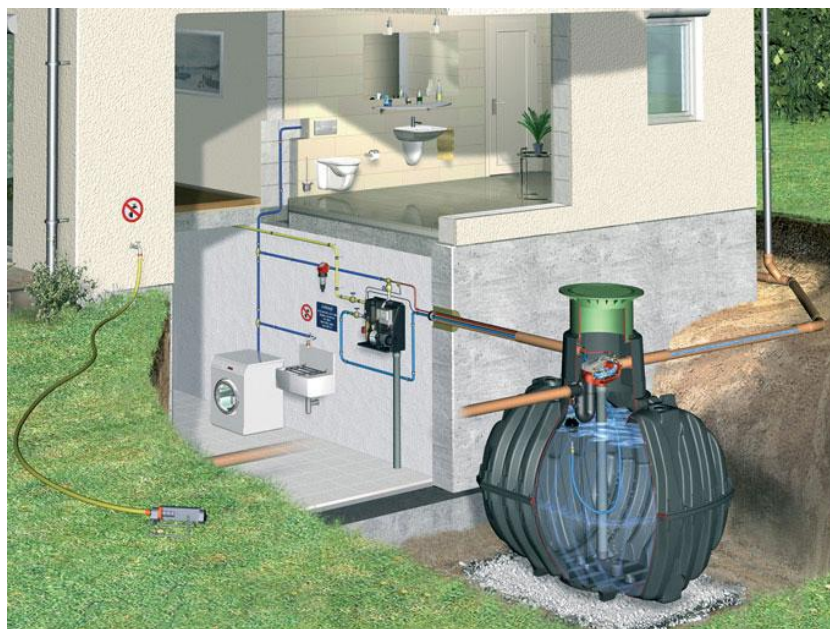
(Gráfico 19, Tratamiento de aguas pluviales.)
