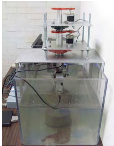
Figura 5.6: Fotografías del sistema construido de tomografía ultrasónica. a) Vista Frontal, b) Vista Lateral
