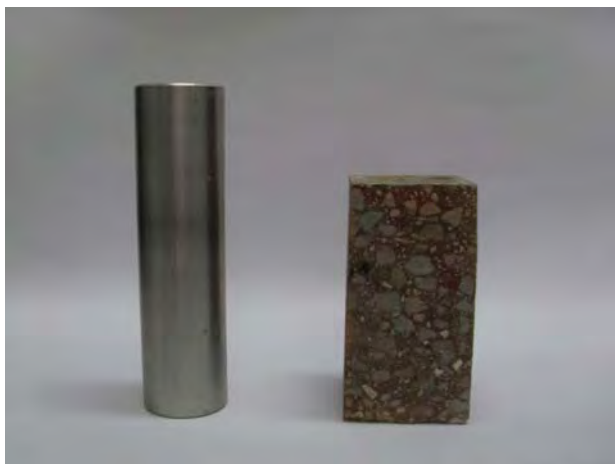
Figura 5.14: Fotografía de las probetas utilizadas en la inspección de tomografía ultrasónica. A la izquierda se muestra la probeta cilíndrica de Aluminio, mientras que a la derecha la probeta cúbica de Concreto.
