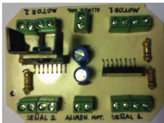
Figura 2.15: Fotografía del circuito implementado para el control de potencia.
