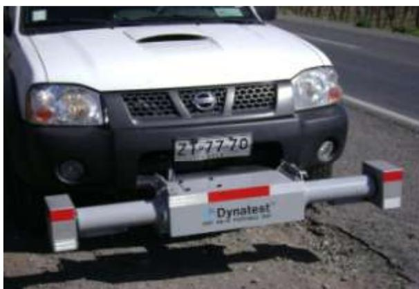
Fig. II.8.- Perfilógrafo Inercial marca Dynatest (Fuente: Dynatest.com).
