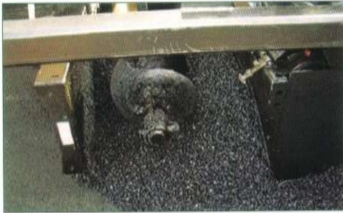
Fig. V.4.- Movimiento de tornillo sinfin de la pavimentadora (Fuente: fotografía propia del autor).
