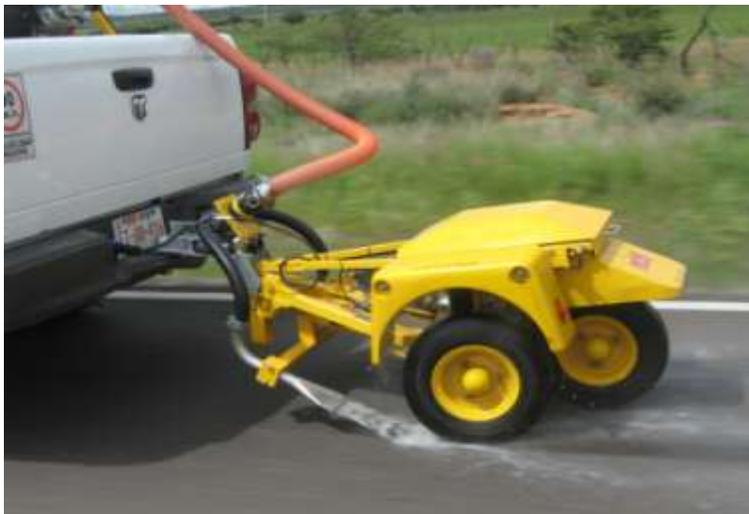
Fig.I.10.- Mu meter en prueba de fricción dinámica (Fuente: Constructora Cien.com).
