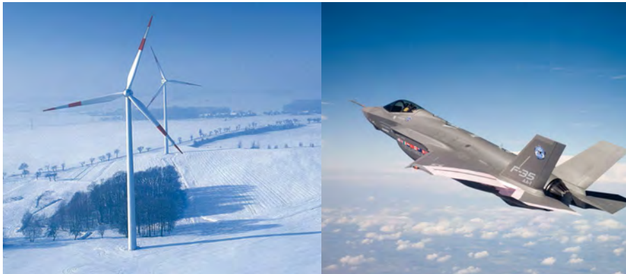
Figura 1.13 Materiales compuestos en (a) alabes de turbinas eólicas (b) jets militares [10].
