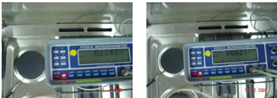
**Figura 25.** Micro manómetro para medir la presión interna de la mezcla.
