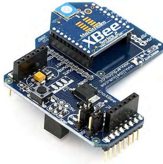
Figura 12. XBee montado sobre el shield para el microcontrolador Arduino [19]
