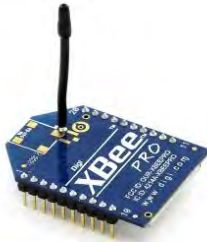
Figura 11. Módulo de radiofrecuencia XBee [18]
