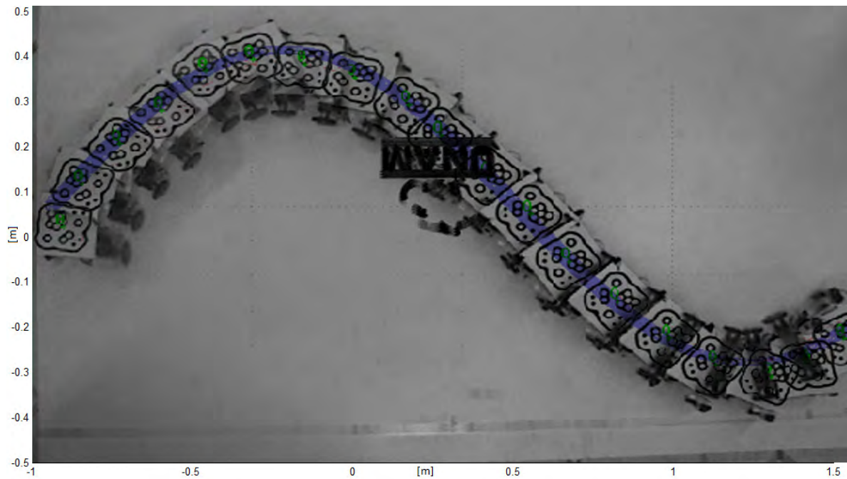
Figura 42. Secuencia de imágenes obtenidas del video que muestran el desplazamiento del robot móvil y en azul la trayectoria de referencia.
