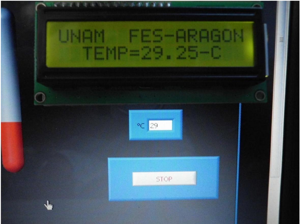
*Figura C-2 Ejecución de LabVIEW y comparación con el módulo LCD*
