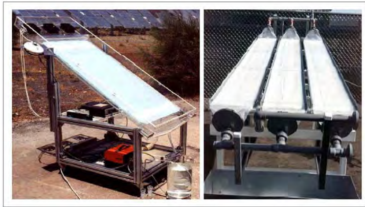
Figura 51. Izquierda: captador solar estático de placa inclinada (PSA). Derecha: prototipo de captador tubular (National Renewable Energy Laboratory, USA)
