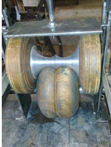
Figura 86. Dispositivo para doblado de las láminas reflejantes.
