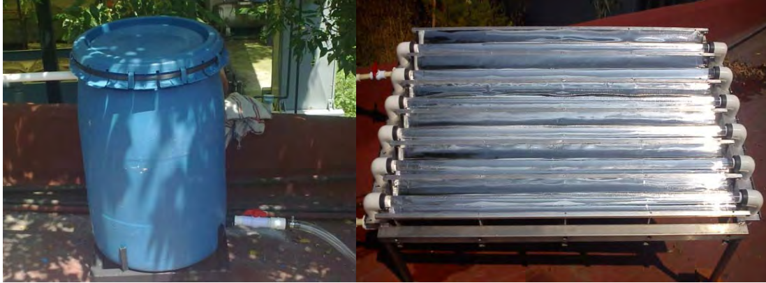
Figura 75. El agua se conduce del filtro al fotorreactor (izquierda y derecha). El fotorreactor (derecha).
