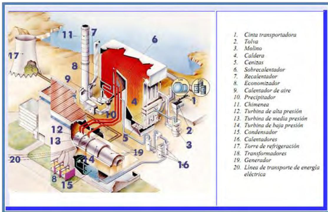
**Fig. 4. 5 Partes Internas de una Termoeléctrica**
