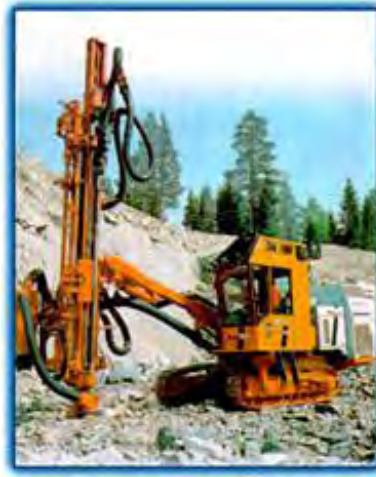
Fig. II.10. Máquina rotaria para barrenación larga, generalmente utilizada para explotaciones a cielo abierto o para trabajos de exploración
