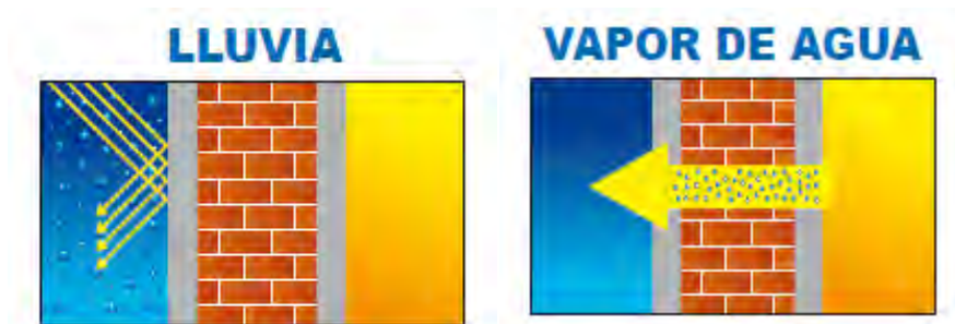
FIGURA 100. Diagrama de funcionamiento de la pintura.
