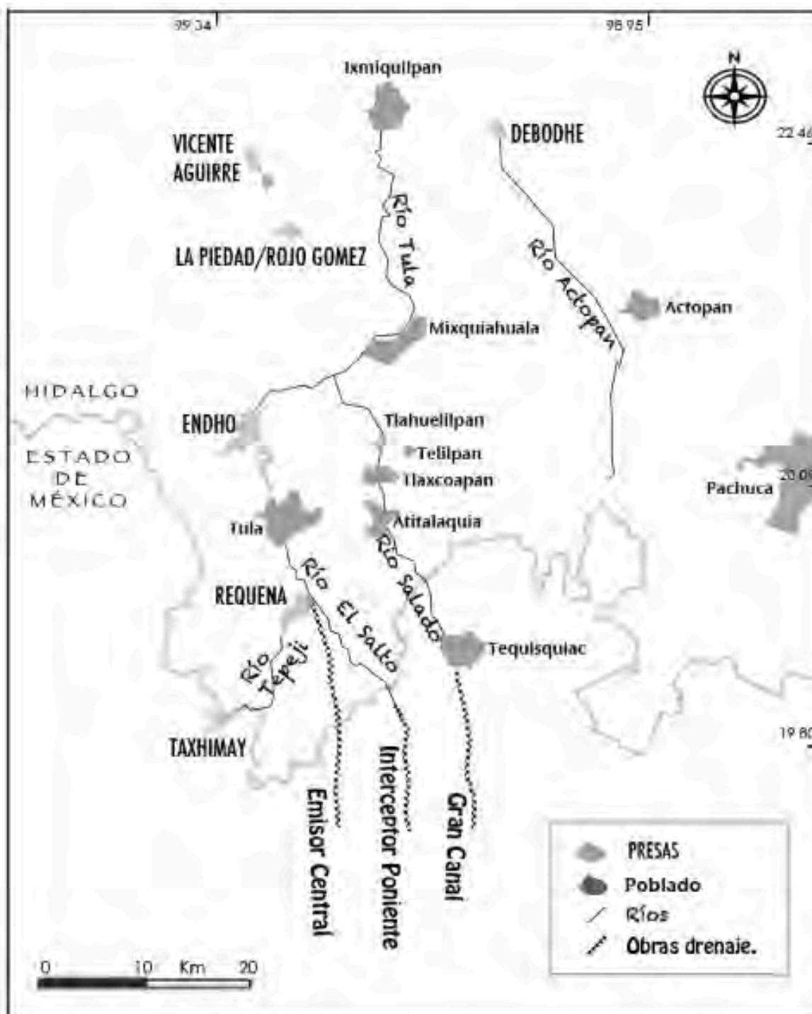
Fig. 3.5. Localización de ríos, presas y obras de drenaje en el Valle del Mezquital.
