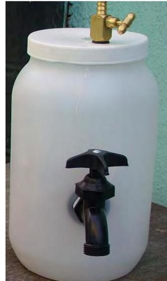
Figura 3.6 Fotografía del reactor anaerobio a escala laboratorio (vista frontal)
