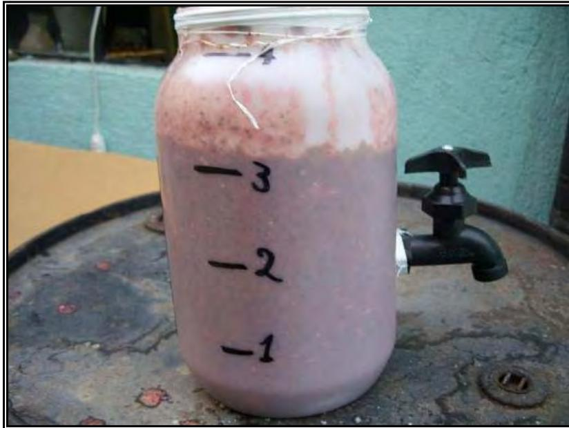
Figura 3.8 Fotografía del digestor con la carga inicial del arranque
