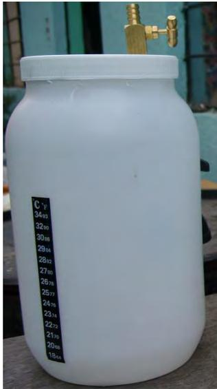
Figura 3.5 Fotografía del reactor anaerobio a escala laboratorio (vista lateral)
