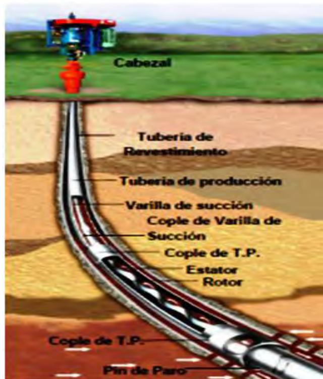
Figura 3.5 Componentes de la bomba de cavidades progresivas
