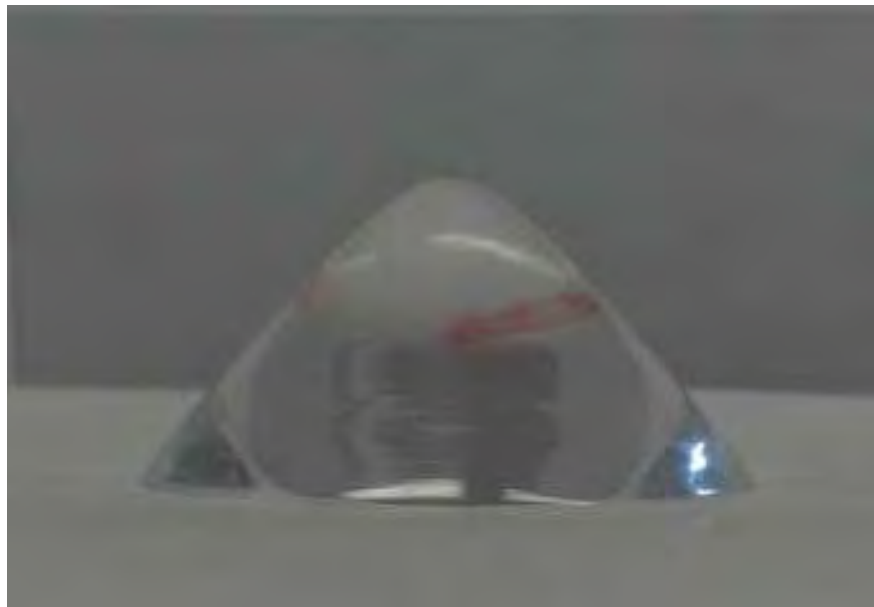
Fig. 3.12 Elemento de detección paraboloides en perspectiva con el dibujo de fondo
