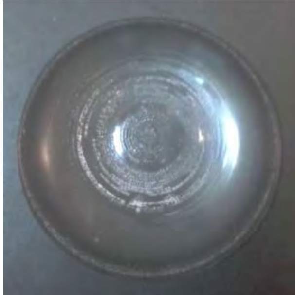
Fig. 3.35 Elemento de detección elíptico deteriorado al hacer mediciones con acetona
