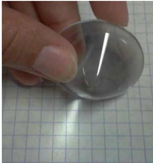
Fig. 3.17 Elemento de detección paraboloide y patrón de luz
