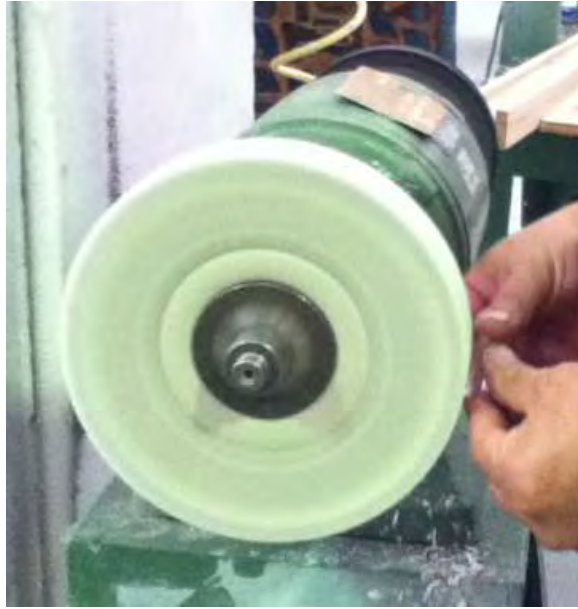
Fig. 3.8 Pulido con el esmeril
