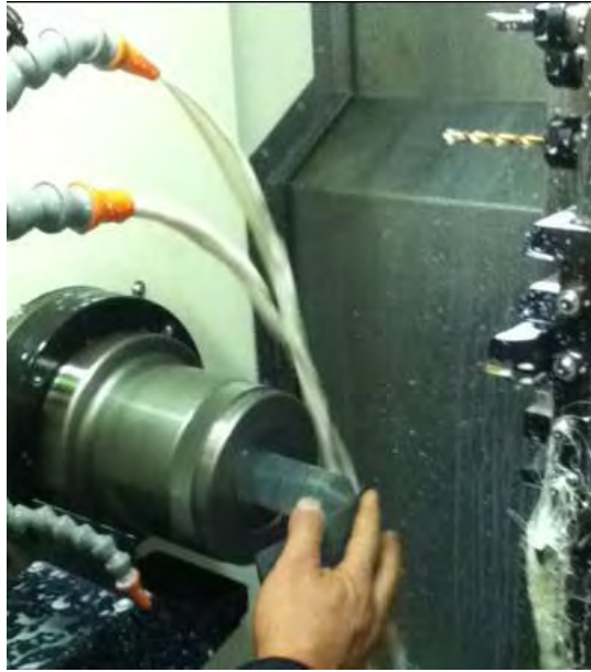
Fig. 3.4 Pulido con lija de agua
