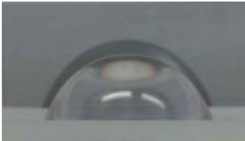
Fig. 3.14 Elemento de detección elíptico con dibujo de fondo
