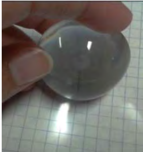
Fig. 3.18 Elemento de detección elíptico con patrón de luz
