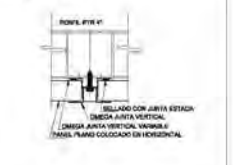
Detalle union panel Arval con PTR
