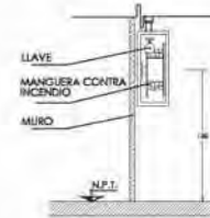
DETALLE INSTALACION EXTERIOR CON MANGUERA EN PARED
