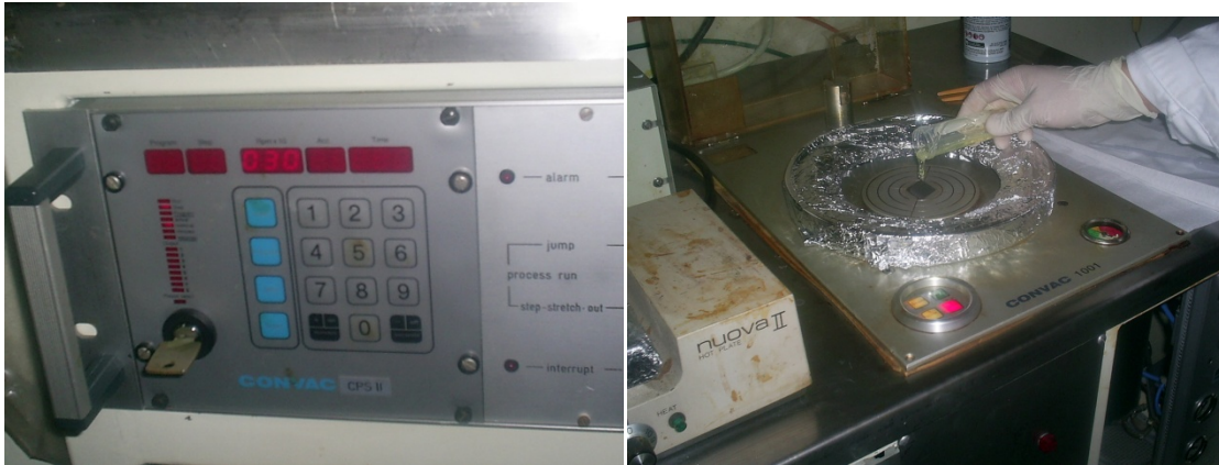
Figura 2.10a. Panel de control del spin coater. Figura 2.10b. Colocación de la resina en la oblea
