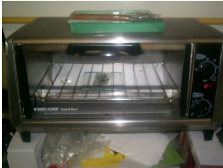
Figura 2.5 Horno donde se introducen los Shrinky-Dinks para reducir, a 280°C
