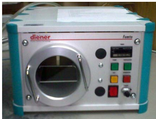
Figura 3.3 Horno de plasma utilizado en este trabajo para la activación de superficies de PDMS y vidrio para la microfabricación de microchips
