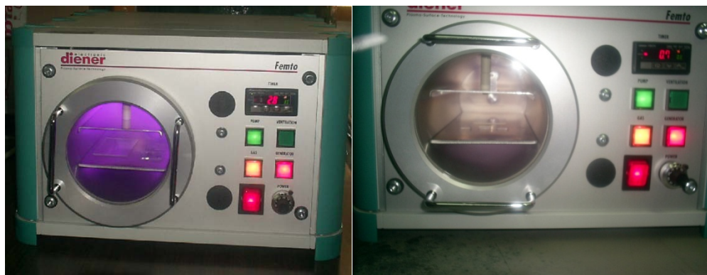
Figura 2.7 Funcionamiento del plasma utilizando como gas generador aire de la atmósfera creando un plasma color morado (Izquierda). Plasma generado utilizando como gas generador O 2 puro, (Derecha)
