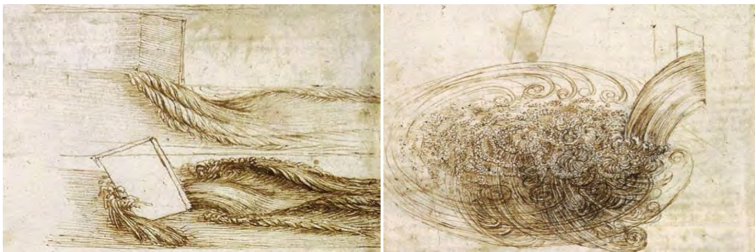
Figura 2.1 Esquemas de Leonardo Da Vinci, sobre estructuras de flujo generadas a la salida de agua por un orificio (panel izquierdo), así como estructuras formadas alrededor de obstáculos (panel derecho). (Da Vinci c.1508).
