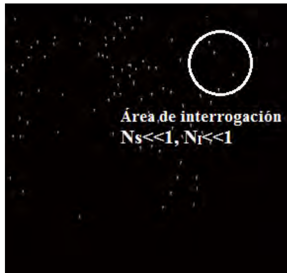
Figura 2.7 Ejemplo de imagen obtenida por medio de un sistema PTV
