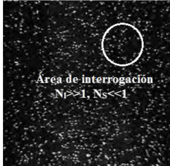
Figura 2.9 Ejemplo de imagen obtenida con un sistema PIV.
