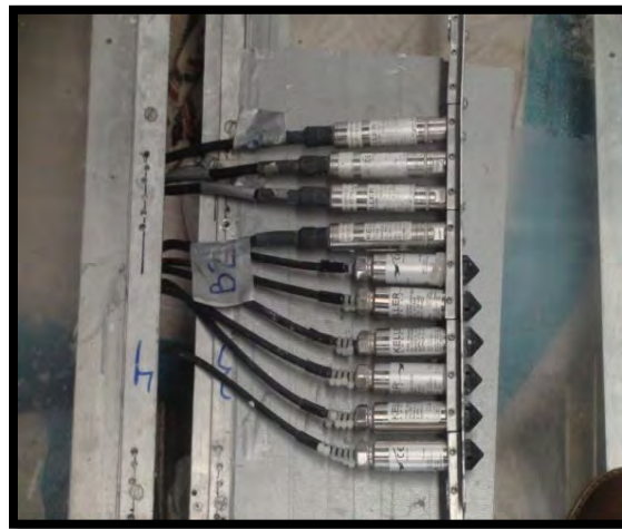
Figura 3.10 Colocación de sensores de presión en la placa de acero inoxidable.
