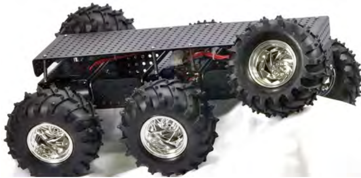
Figura 1.4 Configuración de Skid Steer
