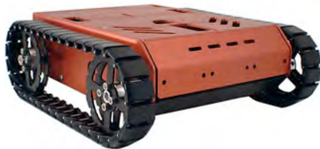
Figura 1.5 Configuración de Pistas de deslizamiento
