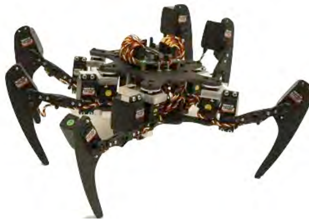
Figura 1.8 Configuración típica de los vehículos con patas
