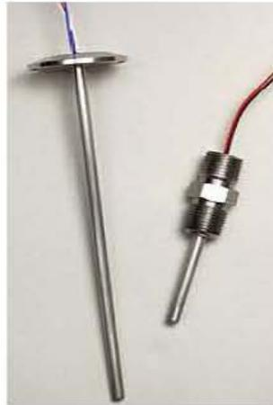
Fig. 4.25 Vista de los detectores resistivos de temperatura
