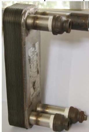
**Fig. 4.22** Vista del condensador (intercambiador de calor de placas).
