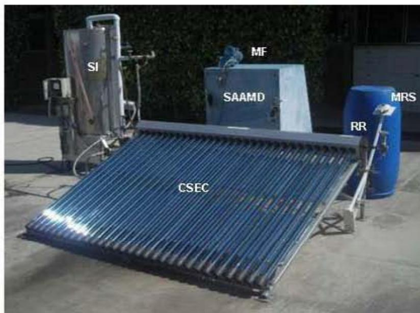
**Figura 3. Sistema de calentamiento solar en circuito hidráulico abierto.**
