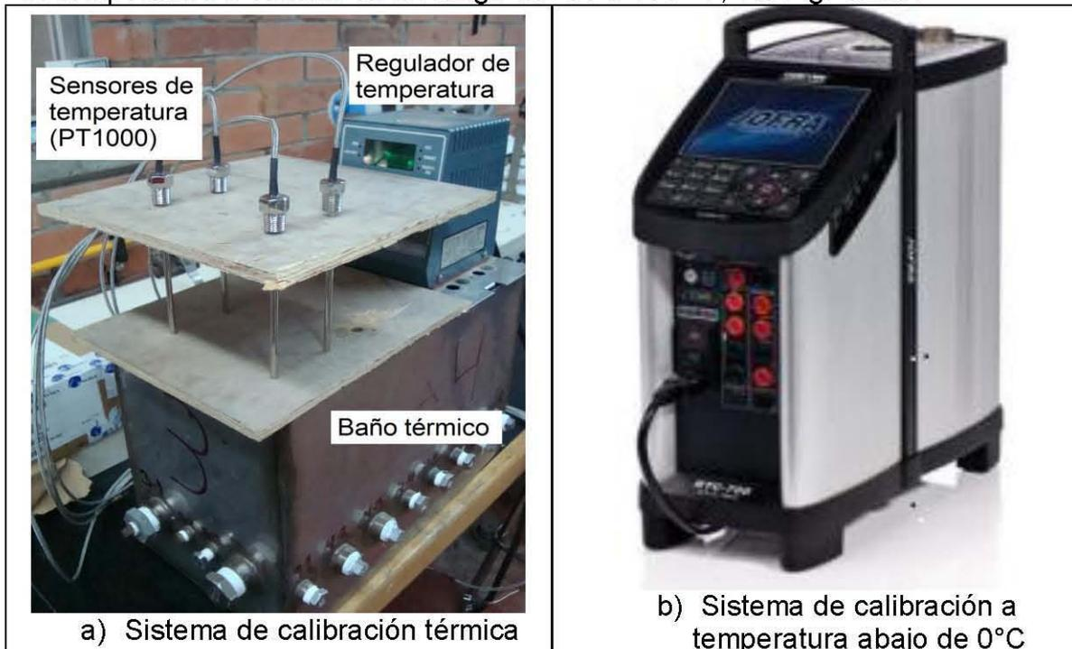
Fig. 4.29 Sistemas de calibración de los sensores de temperatura (PT1000).
