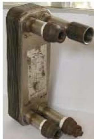
**Fig. 4.24 Vista del evaporador (intercambiador de calor de placas).**
