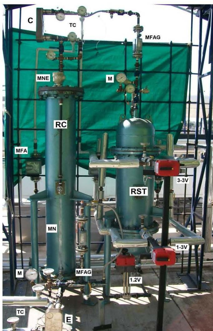
Fig. 4.39 Vista del sistema de refrigeración termoquímico.
