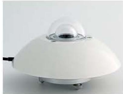
Fig. 4.28 Vista de un piranómetro.
