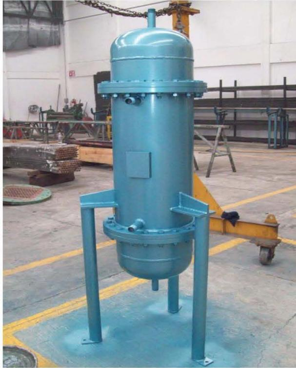
**Fig. 4.21** Vista del intercambiador de coraza y tubos internos (RTS).
