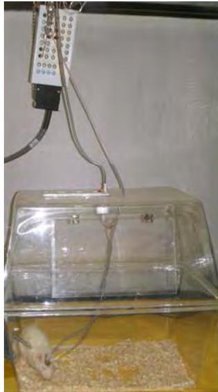
**Figura 7. Condiciones experimentales de registro electroencefalográfico.** Se muestra una rata *taiep* en las condiciones experimentales. Note que el conector en el cráneo de la rata se une mediante los cables a la caja de canales para el registro, esto a su vez se encuentra dentro de una jaula de Faraday para aislar el sistema de interferencias eléctricas.
