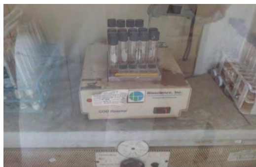
Fotografía 5. Muestras de lixiviado en digestión en el reactor HACH mod 45600-00, para la determinación de DQO.
