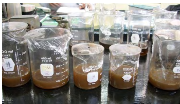
Fotografía 11. Prueba de jarras para el tratamiento del quitosán al 2 %.
