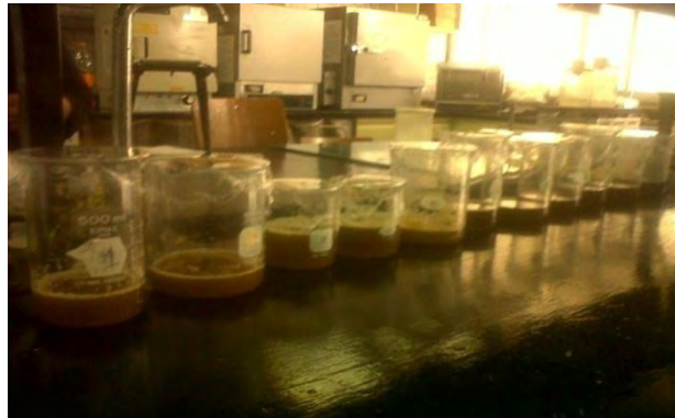
Fotografía 9. Prueba de jarras para la dosis óptima del quitosán al 1%
