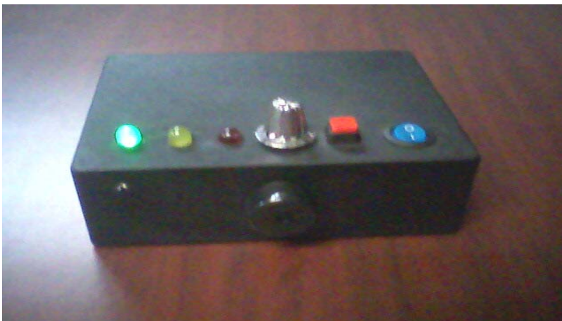
Figura 5. Generador de pulsos acústicos utilizado para la estandarización del test de sedentarismo.
