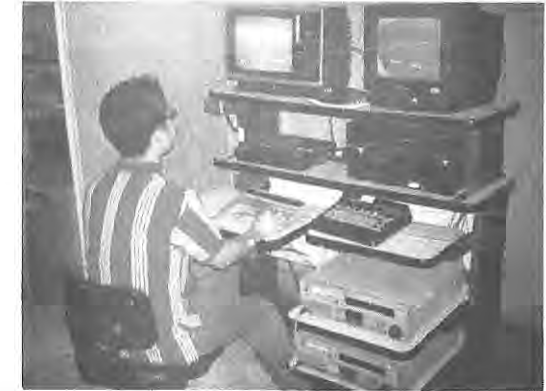
Imagen 142. Edición lineal que utiliza un monitor, una reproductora, una reproductora/grabadora y una consola con switch para combinar efectos.
