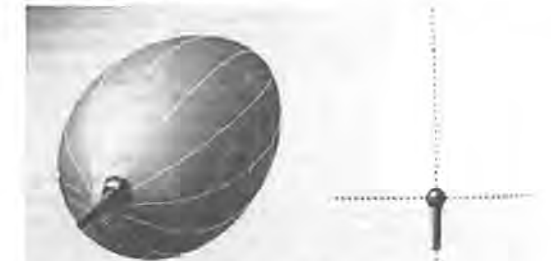
Imagen 103. Micrófono unidireccional, captá el sonido en la dirección que se le dirige.
