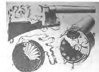
Imagen 16. Revólver o fusil fotográfico, cámara que "disparaba" hasta 100 fotogramas por segundo.
