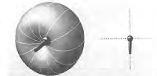
Imagen 104. Micrófono cardioide, capta el sonido en forma de corazón.
