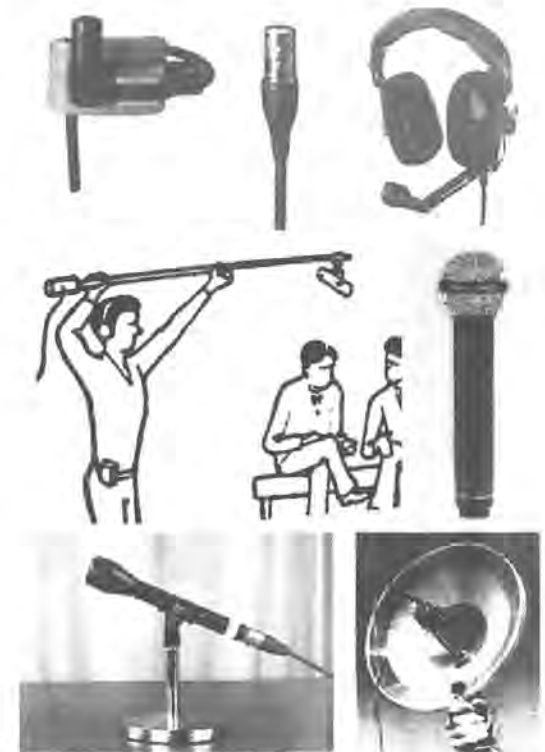
Imagen 106. Los diseños móviles de micrófonos pueden moverse junto con la persona, como el lavalier (arriba izq.), la diadema (arriba der.), el boom (centro izq.) y el de mano (centro, der.). Los diseños estacionarios son de escritorio (abajo izq.) y parabólico reflector (abajo der.).
