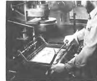
Imagen 50. Para comprimir todos los acetatos sobrepuestos se ponen en registro y se aplica sobre ellos una placa de cristal a modo de prensa para filmarlos.
