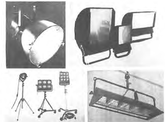
Imagen 108. Las lámparas difusas como la cazuela (arriba izq.), los softlights (arriba der.), los minibrutos (abajo izq.) y la diablo (abajo der.) iluminan áreas grandes y borran sombras con luz suave.
