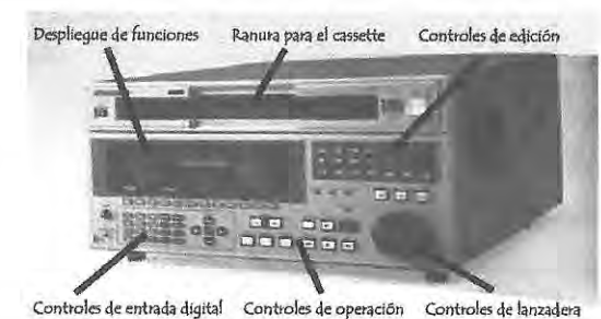
Imagen 143. Reproductora/grabadora digital Betacam SX, equipo no lineal y muy costoso.
