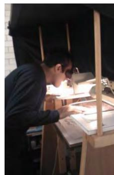
Figura 33. Trazo de las Curvas de Nivel utilizando el restituidor.
