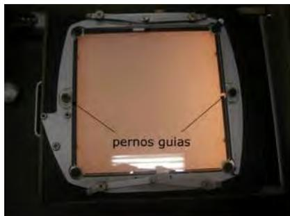
Figura 28 porta placas del restituidor. Fuente: Elaboración propia.
