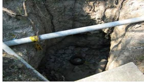
Fotografía 2. Se observa que al fondo del hundimiento existen fragmentos de roca que se han ido cayendo de las paredes debido a lo deleznable de las arcillas y limos que contienen los diferentes estratos de la roca.
