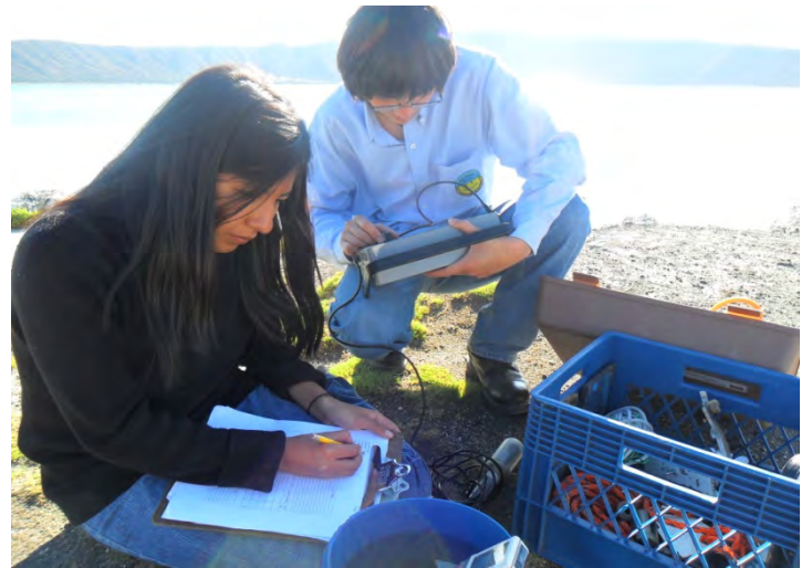
Figs. 40, 41, 42, 43.- medición insitu de alcalinidad, pH y conductividad del lago Alchichica 2009-2010.
