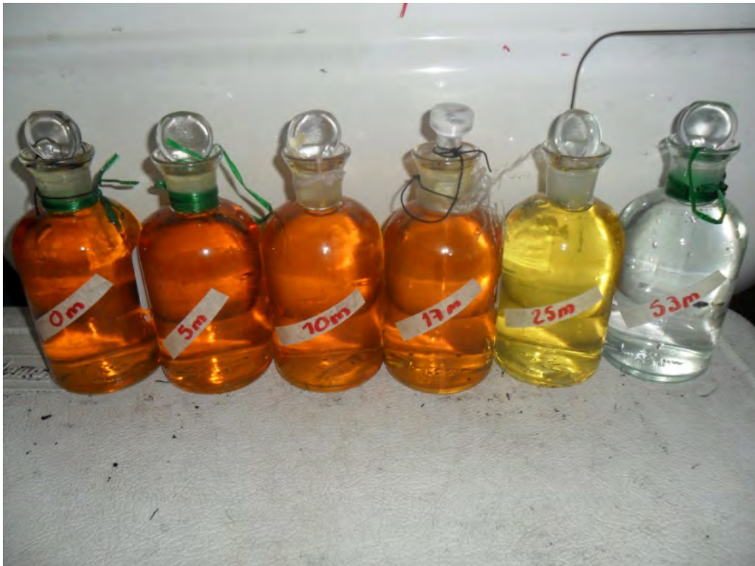
Fig. 44.- medición de oxígeno disuelto por el método de winkler, julio 2009. Fig. 45.- medición de oxígeno disuelto por el método de Winkler, agosto 2009.
