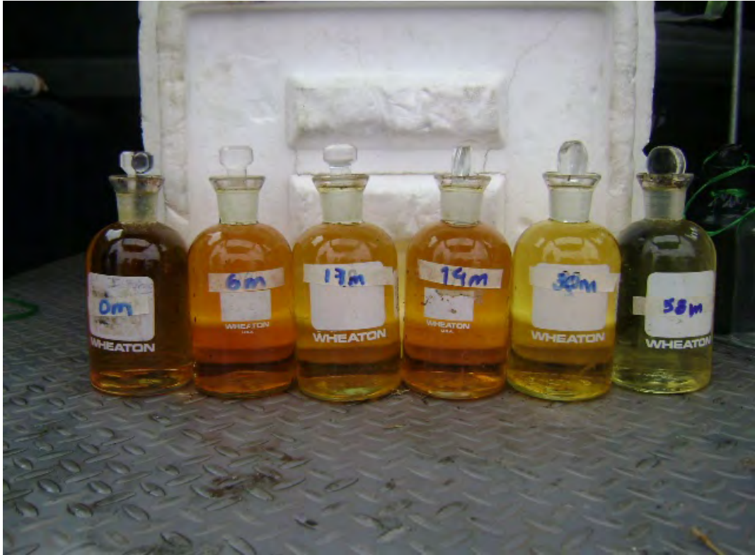
Fig. 44.- medición de oxígeno disuelto por el método de winkler, julio 2009. Fig. 45.- medición de oxígeno disuelto por el método de Winkler, agosto 2009.
