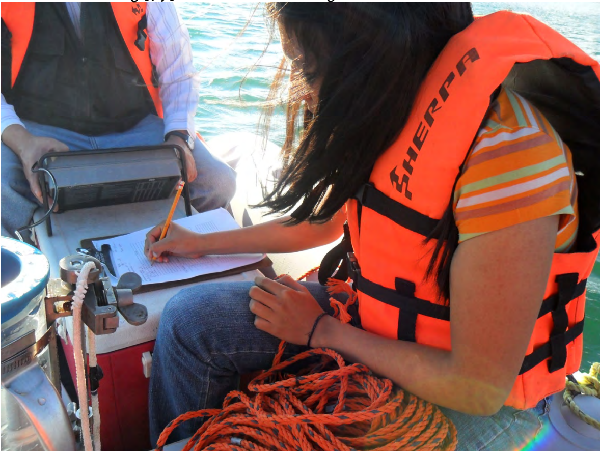
Fig. 39.- medición de parámetros insitu (temperatura, O.D., salinidad) en el lago Alchichica.
