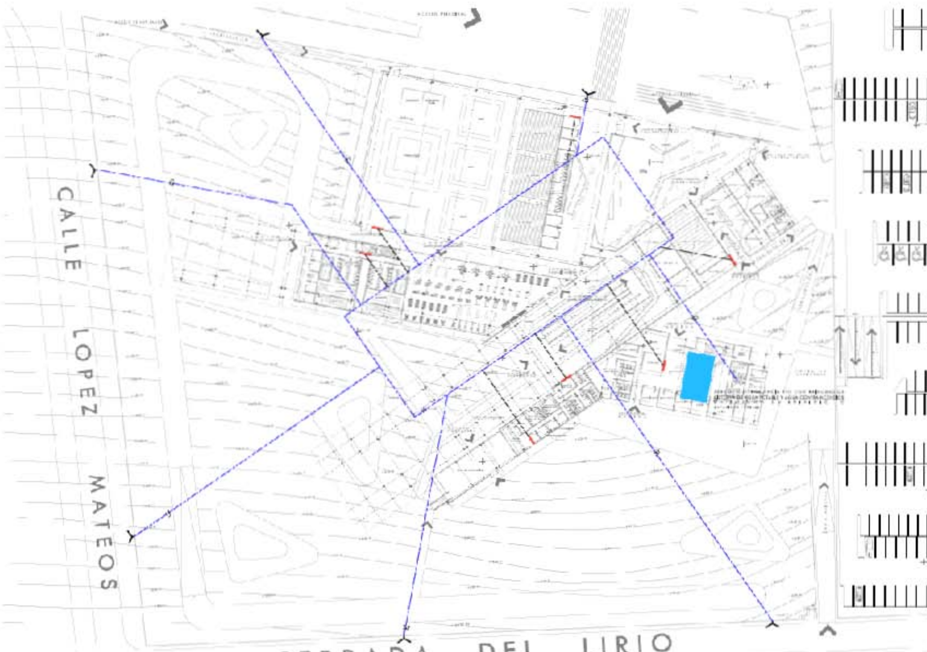
PLANTA CONJUNTO RED CONTRAINCENDIOS ESCALA 1:1000
