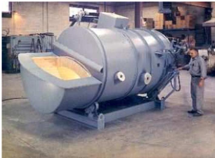
Figura 1.7. Horno cilíndrico de reverbero basculante<sup>4</sup>.
