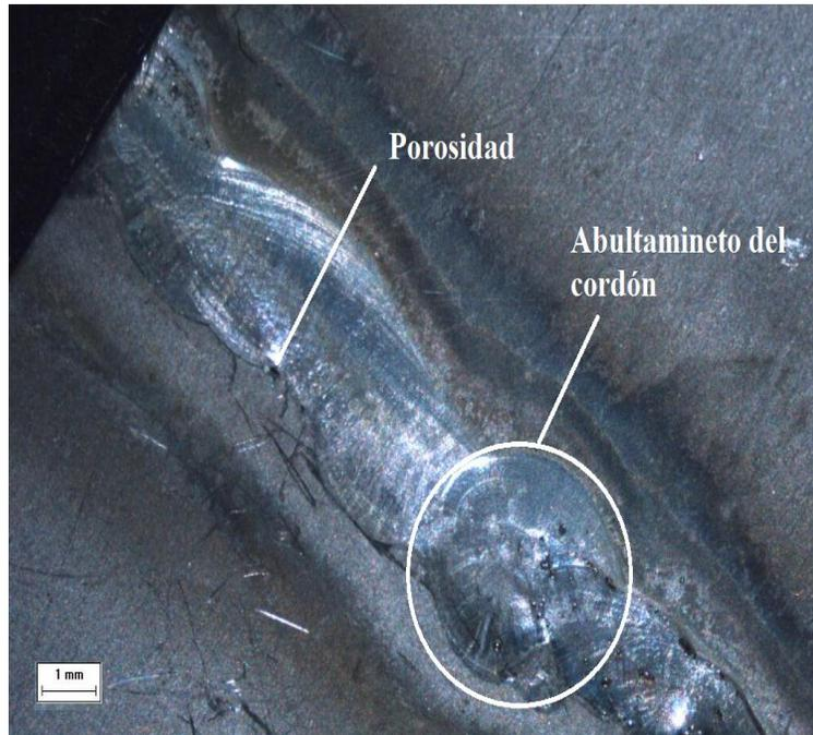
**Figura 8.1.1.2.** La fotografía presenta un abultamiento de metal fundido en la parte inferior derecha ocasionado por una velocidad de soldadura no constante, por lo que también se afecta la propagación de calor en la pieza soldada que no sufre fusión, a pesar de esto el cordón es continuo y libre de defectos superficiales.
