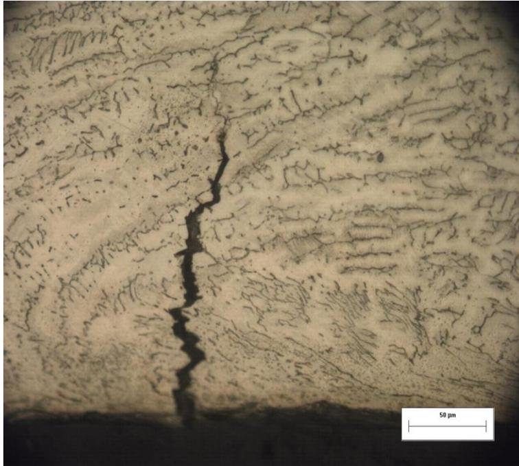
**Figura 8.2.6.4** Se muestra la misma grieta a 500X , la grieta se genera (nuclea) en un límite de grano y después se propaga entre los granos y a través de ellos .
