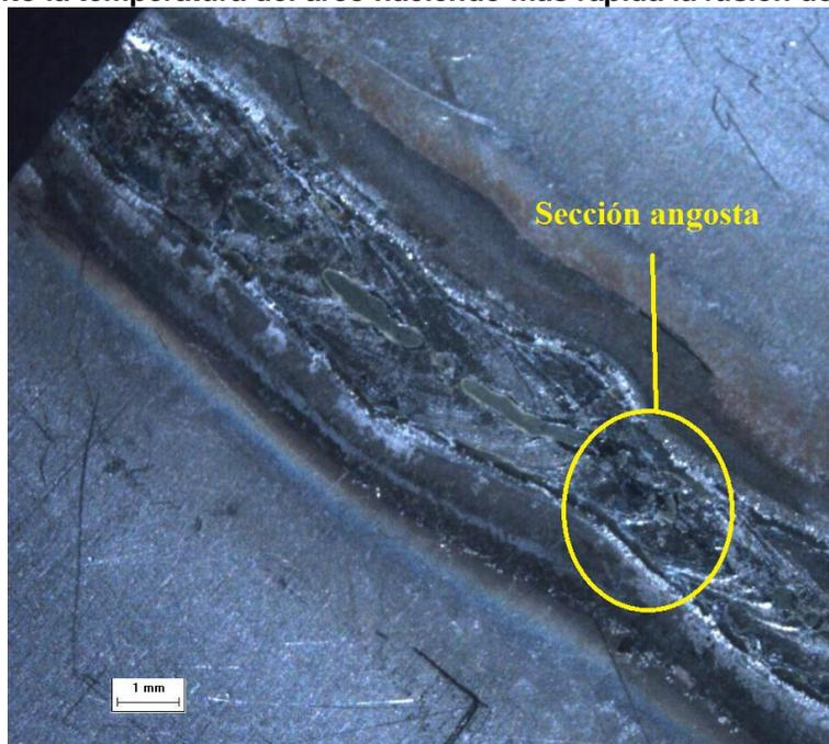
Figura 8.2.1.2 En la imagen se observa un cordón estrecho y alargado, también se observa una zona afectada por el calor más amplia en comparación con las muestras protegidas con gas argón
