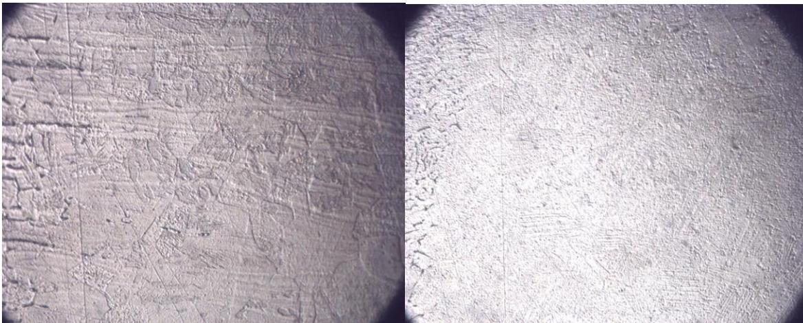
**Figura 8.3.3.2 Metalografías de las zonas afectadas por el calor tomadas a 1000x, a la derecha zona afectada por la protección hecha con argón y la izquierda zona afectada por la protección hecha con la mezcla gaseosa.**
