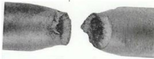
**Figura 6.5.2.2** Fractura de tasa y cono observada cuando se rompe un material dúctil en un ensayo de tensión, el tamaño original de la probeta de prueba era de 0.505plg.
