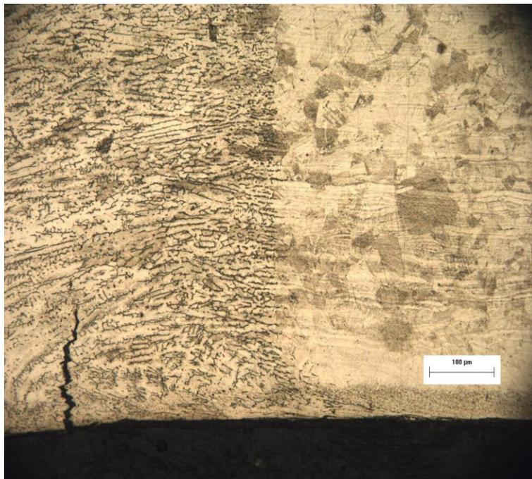
**Figura 8.2.6.3** Se observa claramente una grieta en la zona de fusión.
