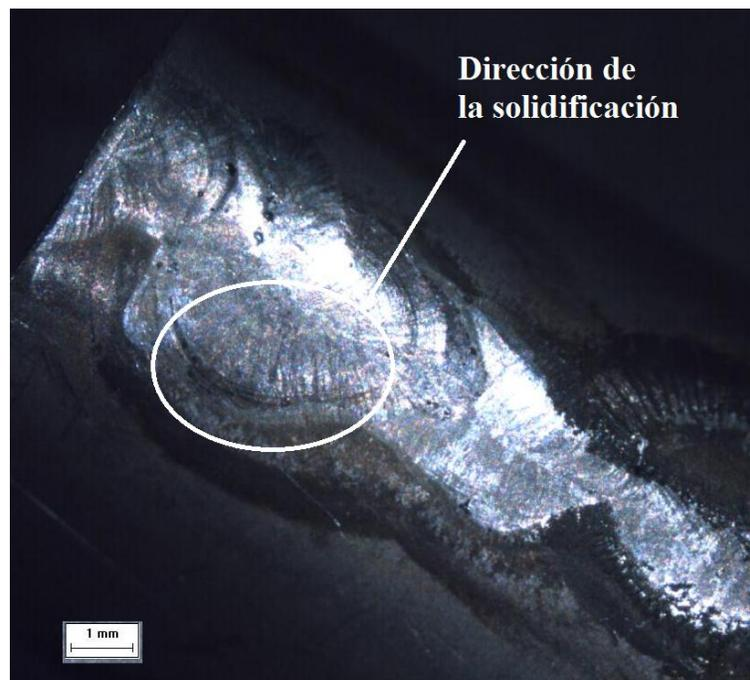
Figura 8.1.2.2 En ésta imagen se logra observar que el cordón resiste mejor al doblez ya que se aprecia una superficie libre de grietas y defectos, por lo que sólo se distingue una unión deformada y la dirección de los granos columnares.
